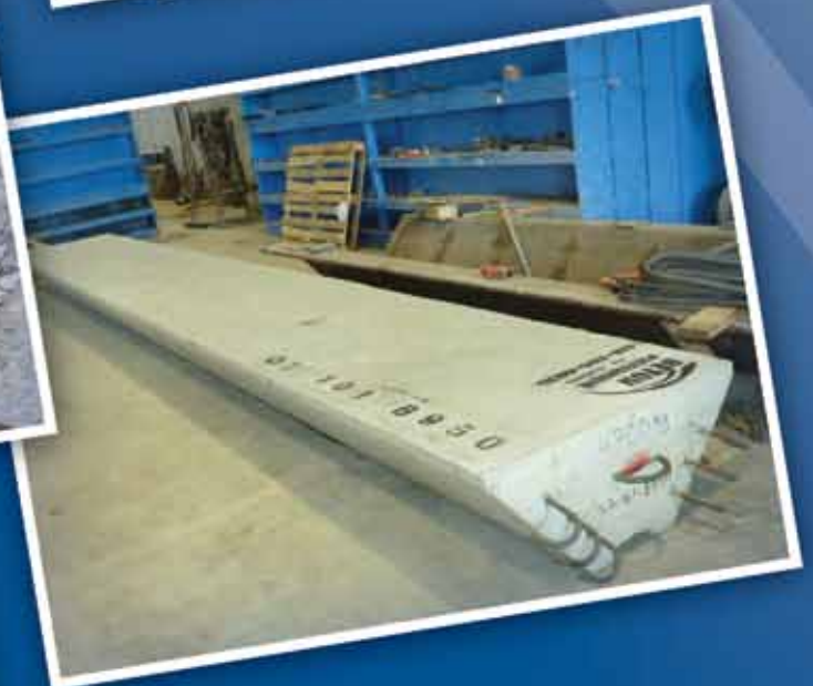
Élément préfabriqué pour palplanches, Quai Alcoa, Baie-Comeau
